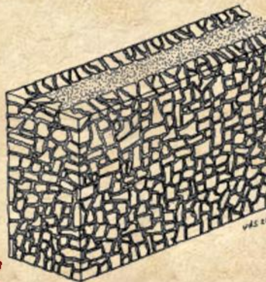
2. Opus incertum: con l'introduzione delle malte e dell' opus caementicium si rende necessario l'uso di paramenti, coerenti con il nucleo, composti di elementi di dimensioni più ridotte. Il più antico tipo di paramento è l' opus incertum , costituito da tufelli di forma piramidale, con il vertice immerso nel nucleo cementizio del muro e la base di forma irregolare lasciata in vista.
